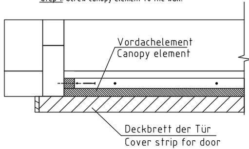
Step 3: Die Verkleidungsteisten in die richtige Länge schneiden und unter das VD-Element befestigen.
